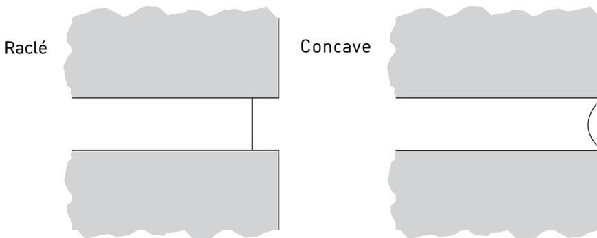
Joint de mortier recommandé 10 mm ( $\frac{3}{8}$  po)
